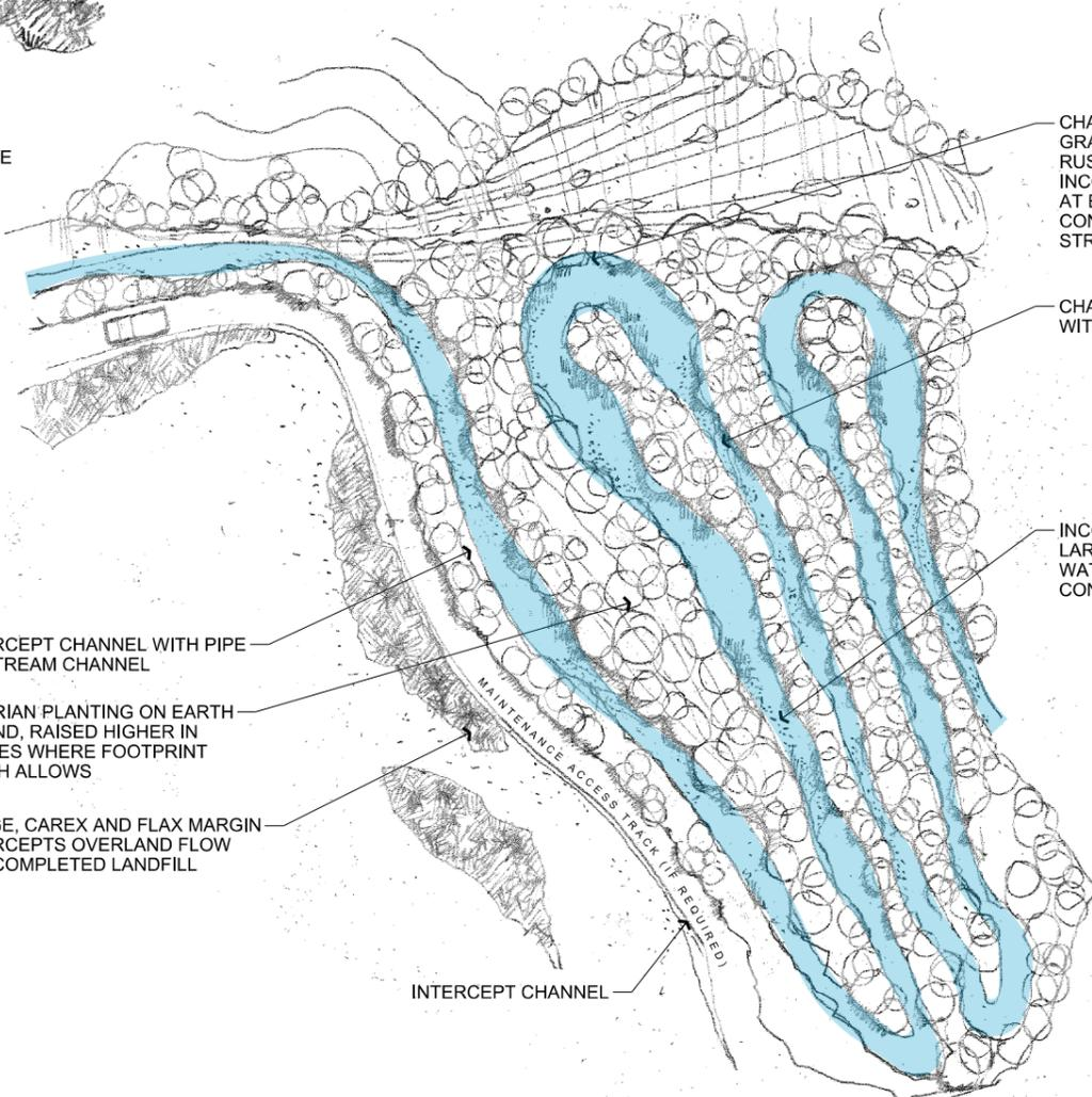
CHANNEL WIDENED AT BENDS, GRAVEL BANKS OR PLANTED RUSHES, SEDGES. INCORPORATED LARGE ROCKS AT BENDS FOR EROSION CONTROL AND IMPROVED STREAM ENVIRONMENT
